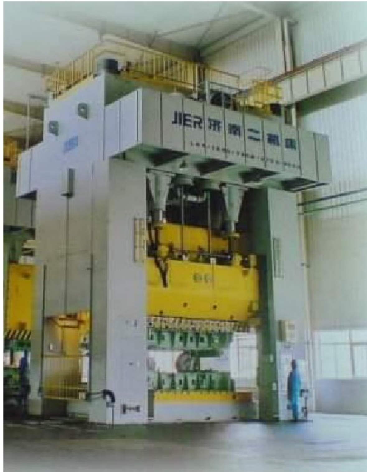
LD4-1250/750B-4700-2500闭式 四点双动拉伸压力机
